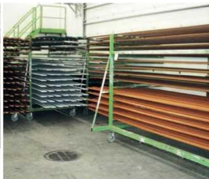
Грунтовка и верхнее покрытие наносятся на двухокрасочных линиях с вакуумными системами. После горячей сушки, доски упаковываются в штабеля по пять.
