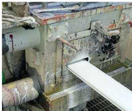
Грунтовка и верхнее покрытие наносятся на двухокрасочных линиях с вакуумными системами. После горячей сушки, доски упаковываются в штабеля по пять.
